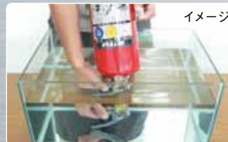
従来の消火器 (水による気密試験)
